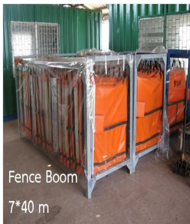
รูปที่ ข.1-13 พุน้ำมันประเภท Fence Boom ความยาวรวม 280 เมตร
